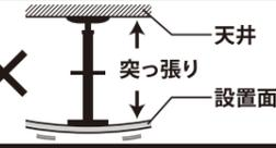
取付後はしっかりと突っ張れているか、必ず確認してください。ぐらつき、転倒の心配がある場合は天井にネジ固定してください。※天井へのネジ固定に関しては、【使用上の注意】にて詳細ご確認ください。※天井固定用のネジは付属していません。
