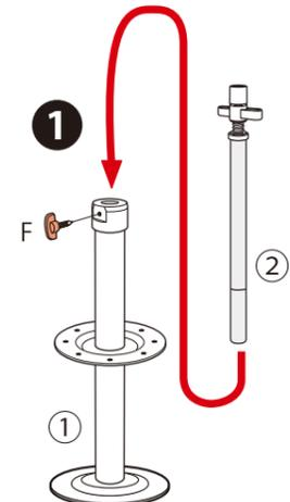
② F 調整パイプ固定ノブで②高さ調整パイプを仮止めします。
