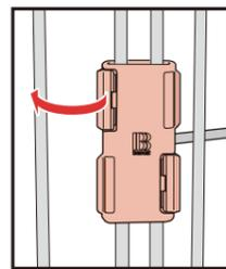
マイナスドライバー等をフック部の隙間に差し込み、破損しないよう慎重に押し開けてください。
